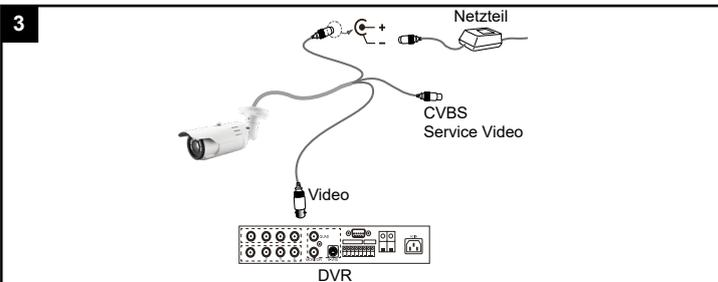
Schließen Sie entweder das Videokabel mit dem gelben oder mit dem grünen BNC-Stecker an ein geeignetes Gerät an (DVR/Recorder, Monitor).
