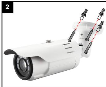
Mit den mitgelieferten Dübeln und Schrauben die Kamera befestigen.
