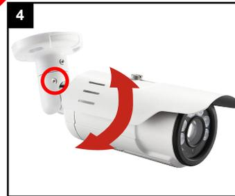
Mit Inbus-Schlüssel ein wenig die abgebildete Schraube lockern, um die Kamera zu neigen. Nicht komplett heraus-schrauben!
